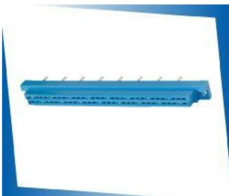
Соединители электрические низкочастотные прямоугольные типов **СНП58** для печатного монтажа и **СНО63** для объемного монтажа, врубного соединения предназначены для работы в электрических цепях постоянного, переменного и импульсного токов при напряжении до 250В, 400В, 1000В (в зависимости от контактности) и силе тока до 2А.
